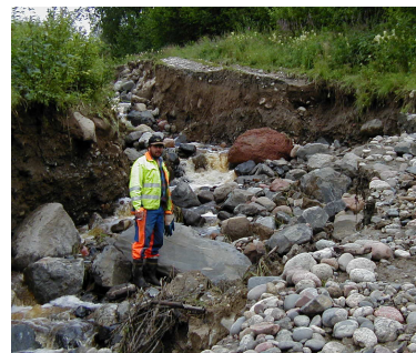
Moränscred i vattenmättad mark i Liden (Boda) i samband med en längre tids kraftiga regn
